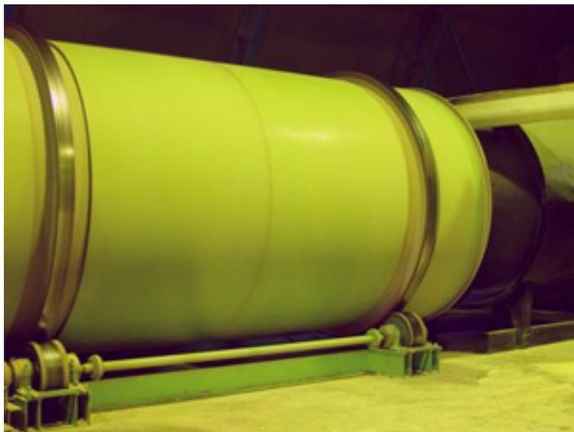
Применяются сушильные барабаны для сушки разных материалов и топлива с высокой первоначальной вязкостью и влажностью. Принцип работы: барабан вращается и в результате этого высушиваемый материал непрерывно перемешивается. Для сушки применяется высокая температура газов. Для сушки в барабане сушильным агентом служить может как горячий воздух, так и дымовые газы.
